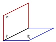
Sean:  $\pi$ : ax + by + cz + d = 0;  $\pi_1$ : a'x + b'y + c'z + d' = 0. La intersección de dos planos es una resta. Los puntos de la recta intersección son aquellos que verifican simultáneamente las ecuaciones de ambos planos. Esto permite utilizar las ecuaciones de los planos secantes para definir la recta:
