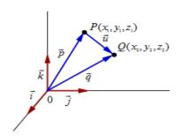
Las coordenadas de un vector libre  $\vec{u} = \left[ \overrightarrow{QP} \right]$  respecto de la base  $B = \left\{ \overrightarrow{i}, \overrightarrow{j}, \overrightarrow{k} \right\}$ , se obtienen restando las coordenadas del punto Q de las correspondientes de P en el sistema de referencia:  $S : \left\{ O, \overrightarrow{i}, \overrightarrow{j}, \overrightarrow{k} \right\}$ .
