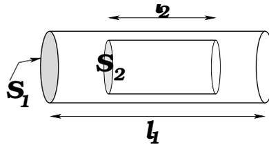
Figura 6.15: Una bobina totalmente dentro de otra.
