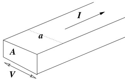
Figura 4.5: Por un conductor de sección  $A$  y ancho  $a$  circula una corriente total  $I$ . Además hay un campo magnético externo  $\vec{B}$  se produce una diferencia de potencial trasversal a la corriente y al campo magnético (en esta figura  $\vec{B}$  es perpendicular a la circulación de la corriente  $I$  y es perpendicular al ancho  $a$ ). La aparición de esta diferencia de potencial trasversal es el efecto Hall.
