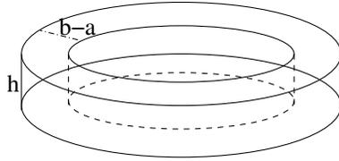
Figura 5.6: Núcleo toroidal con sección rectangular.
