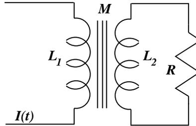
Figura 6.16: Un transformador
