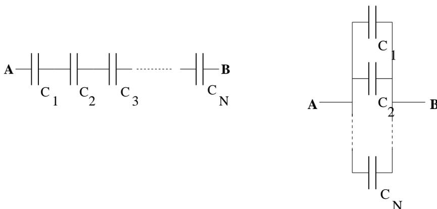
Figura 2.6: Condensadores en serie y en paralelo respectivamente.
