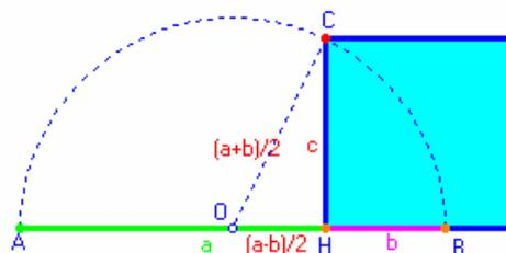
2º Fijando uno de estos triángulos rectángulos CHO, las dimensiones del rectángulo correspondiente,  $a$  y  $b$ , las determinamos trazando la circunferencia de centro O y radio la hipotenusa  $(a+b)/2$ :  $a = AH$  ;  $b = HB$ .
